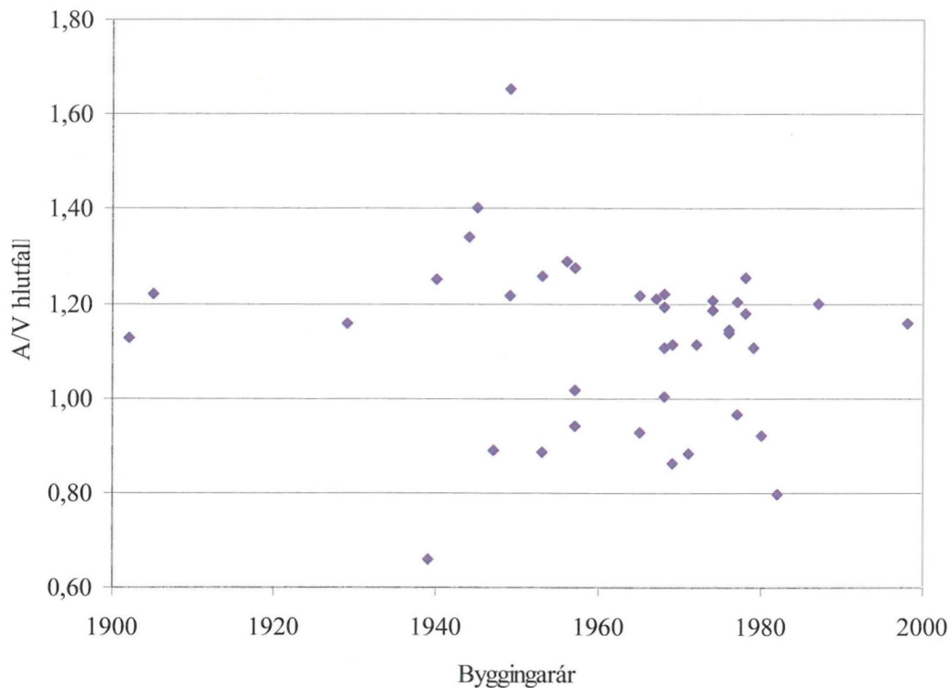
Línurit 2 Hlutfall milli umliggjandi flatarmáls og hitaðs rúmmáls (A/V) eftir byggingarári húsa, hús skoðuð sumarið 2005
